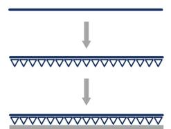
Diese Scheibe verfügt über einen Folienträger mit glatter, reißfester Oberfläche, die eine gleichmäßige Druckverteilung und kontrollierten Abrieb gewährleistet.
